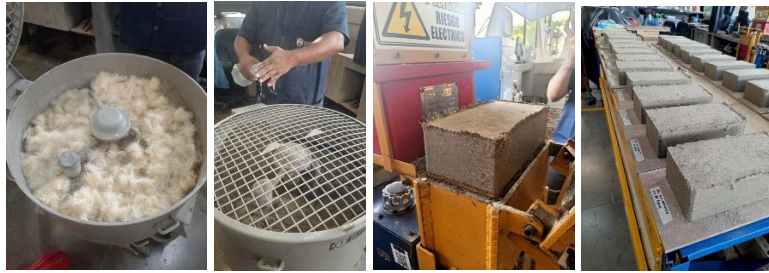
Figura 33. Mezcla y forma del bloque con adición de 0,1% de fique.
