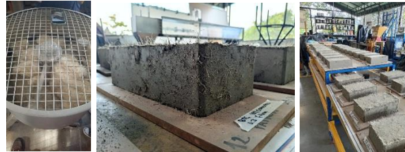
Figura 34. Mezcla y forma del bloque con adición de 0,3% de fique.
