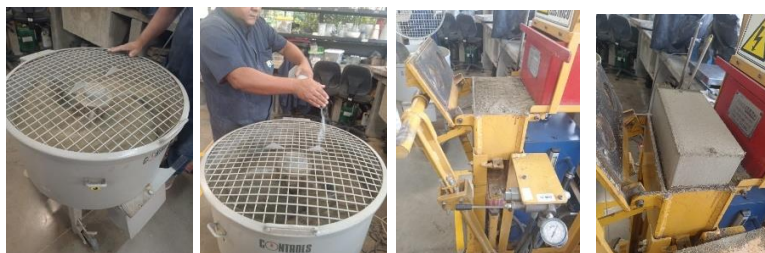
Figura 32. Mezcla y forma del bloque de control (Tradicional).
