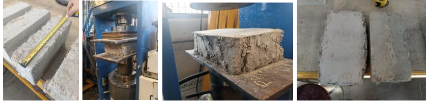
Figura 39. Toma de medidas de los distintos grupos de BTC y fallado en la maquina universal.
