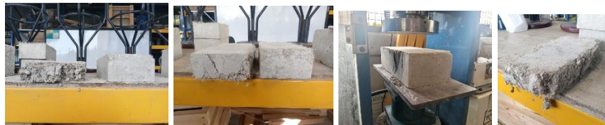
Figura 40. Toma de medidas de los distintos grupos de BTC y fallado en la maquina universal.
