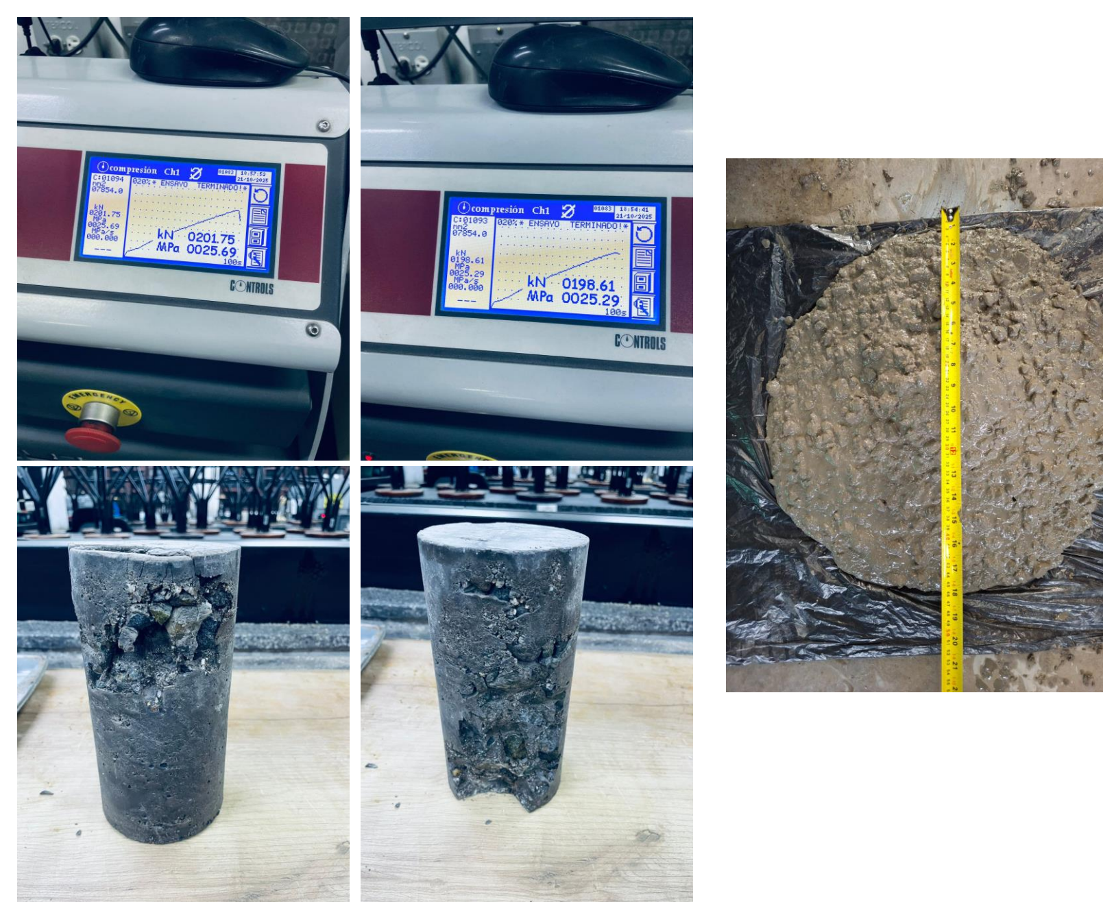
Figura 3. Fallado de cilindros con residuos mineros.
