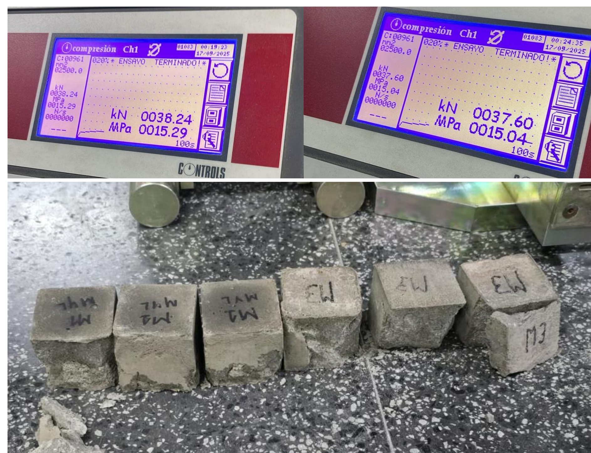
Figura 3. Fallado de cubos con residuos mineros.
