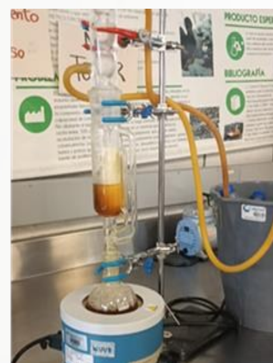
Extracción del aceite de canela por arrastre de vapor
