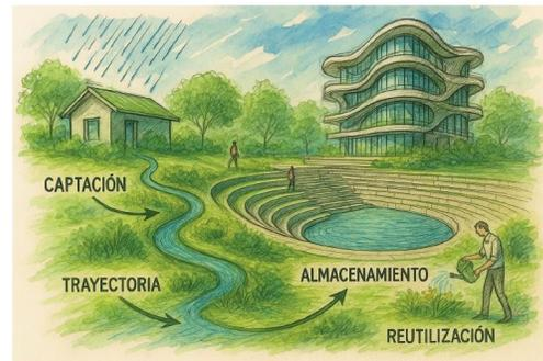
Este proyecto busca mitigar las inundaciones en Medellín mediante la recolección, contención y desaceleración del agua lluvia antes de que llegue a las quebradas. A través de estrategias como jardines de lluvia, pavimentos permeables y tanques de retención, se reduce el escurrimiento superficial y se promueve una gestión sostenible del agua.
