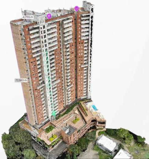
Nube de puntos densa 3D detallado de fachada (toma de medidas)
