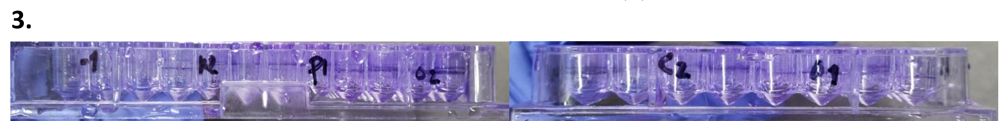
FIGURA 4. Placas de poliestireno teñidas con cristal violeta al 0.25%, para la detección de biopelículas.
