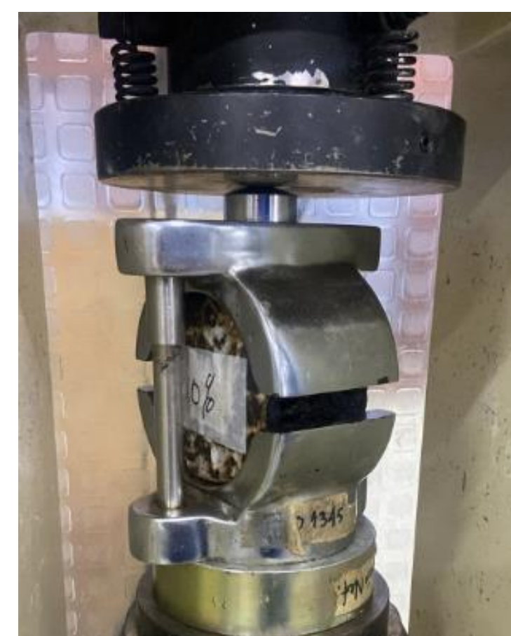
Figura 3. Ensayo de estabilidad. Elaboración propia.
