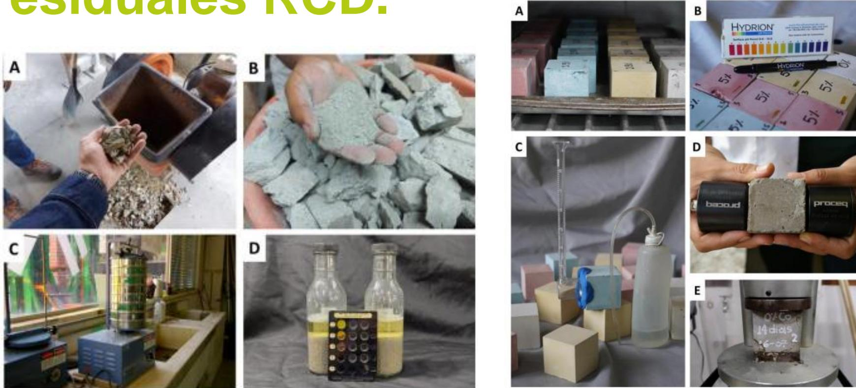
Una vez realizado el diseño de mezclas, se procede a realizar pruebas físicas: ensayos de resistencia a la penetración de humedad, pruebas de pH,
