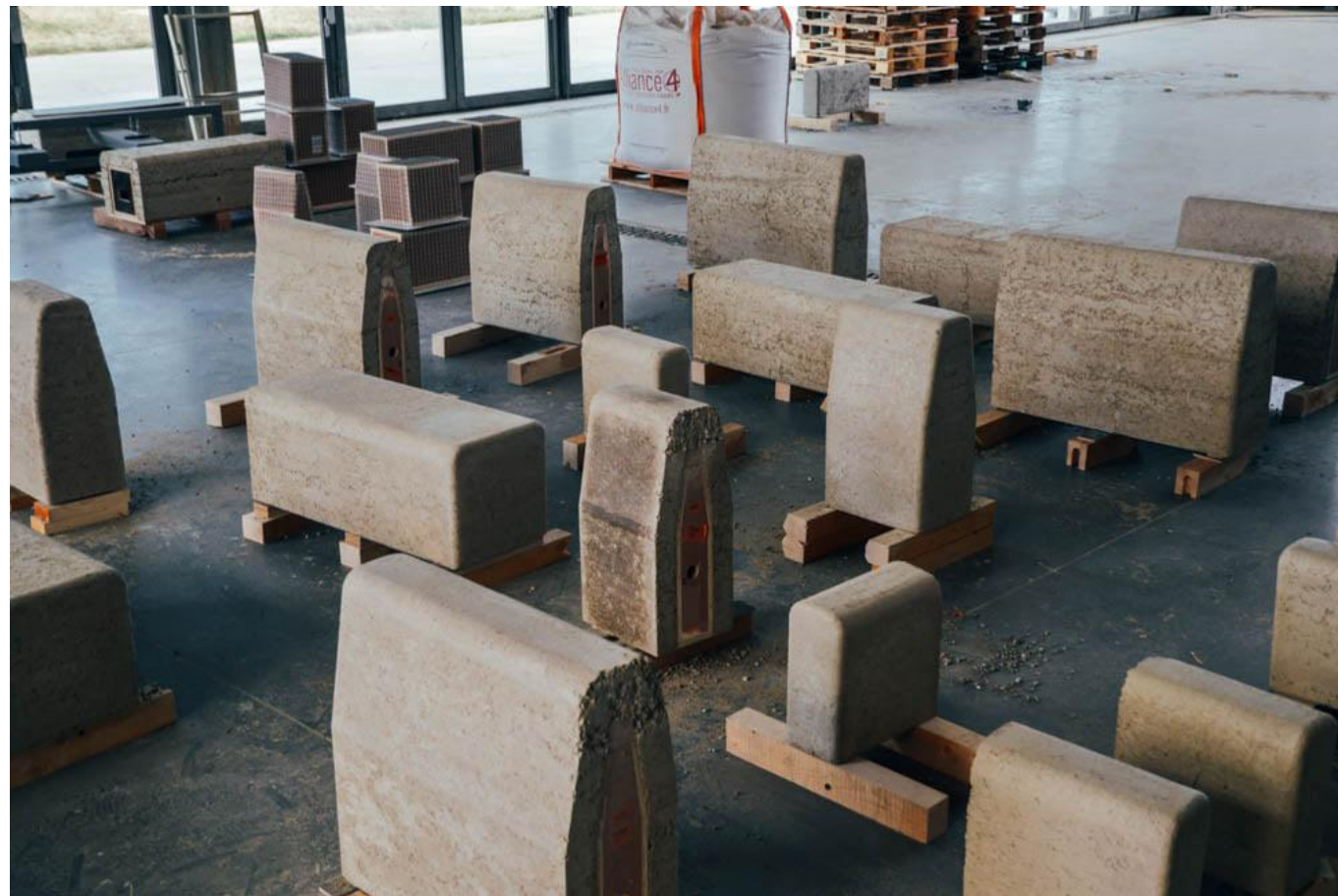
Mobiliario en Tapia -Saint Denis Francia AMACO. 2020 Tomado de: sitio oficial AMACO Atelier Metiere à construire
