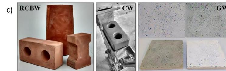
Figura 14. a) Esquema metodológico, b) Resistencia a la compresión de RCD activados con NaOH y waterglass y c) Prototipos de materiales de construcción (ladrillos rojos de arcilla - RCBW, residuos de hormigón -CW y residuos de vidrio – GW, waterglass - Na<sub>2</sub>SiO<sub>3</sub>). Robayo-Salazar, 2017.
