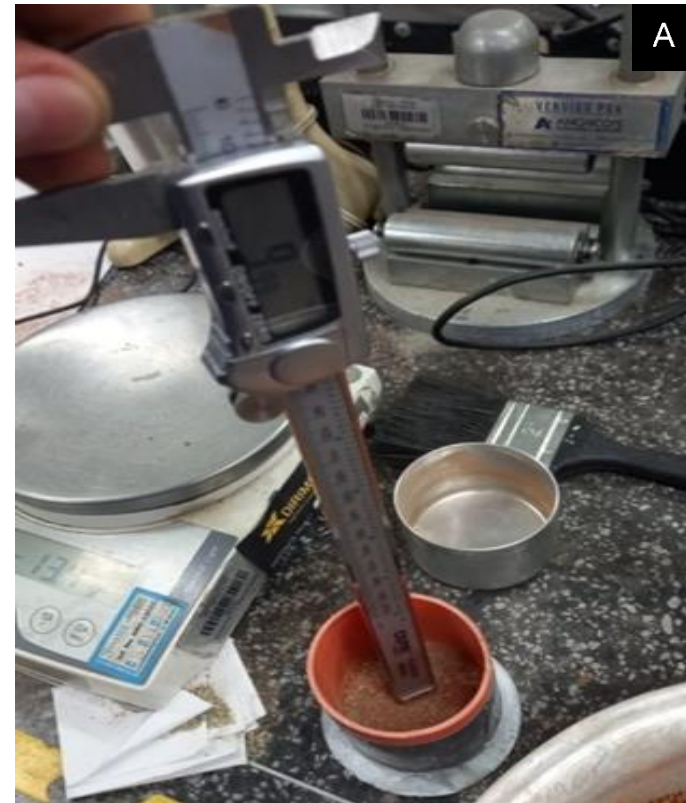
Imagen 8. Proceso de elaboración de muestras del sistema completo de mortero no adherido (recebo / mortero). A) Contiene: Medición con pie de rey para espesor de recebo. B) Contiene: Recipiente con recebo compactado a 1 cm.
