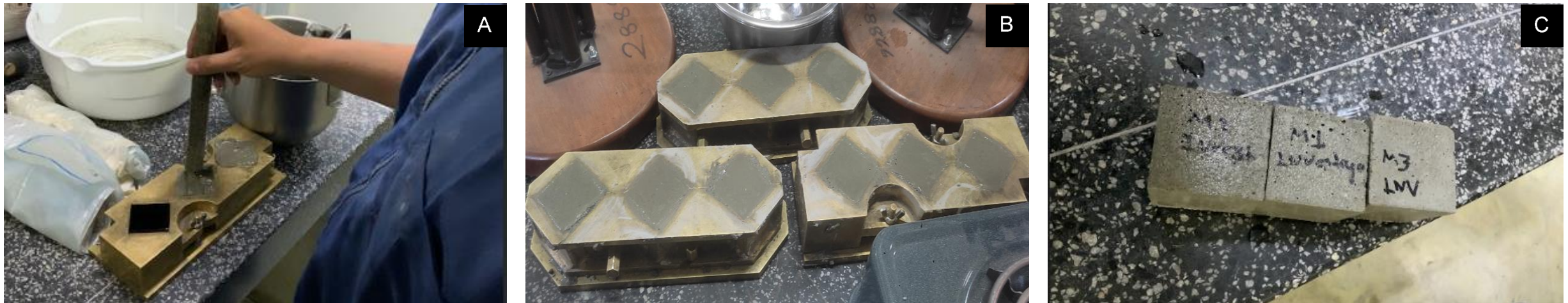
Imagen 5. A) Contiene: Llenado de moldes en cobre para muestras de mortero y apisonamiento de mortero según NTC 220. B) Contiene: Moldes para cubos de concreto con muestras ya vaciadas. C) Contiene: Muestras M1, M2, M3, cubos de mortero desmoldados.
