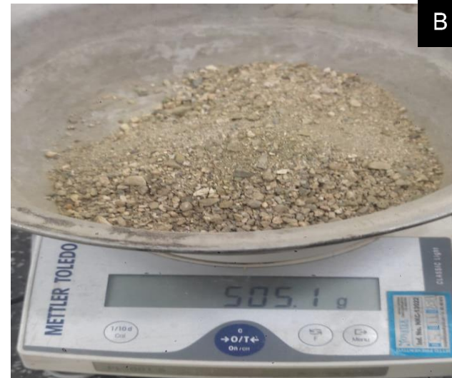
Imagen 7 . A) Muestra de ladrillo triturado para ensayo granulométrico. B) Contiene: Peso de arena de concreto para Fuente: Elaboración propia.
