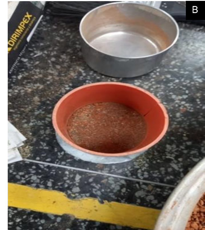
Imagen 8. Proceso de elaboración de muestras del sistema completo de mortero no adherido (recebo / mortero). A) Contiene: Medición con pie de rey para espesor de recebo. B) Contiene: Recipiente con recebo compactado a 1 cm.
