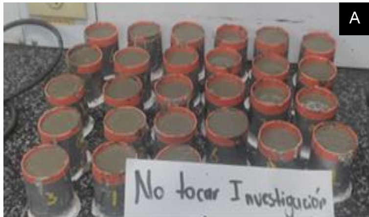
Imagen 9. Secado de muestras, sistema completo (recebo/mortero). B) Contiene: Resultado de muestra 9AL arrojado por la máquina de compresión. C) Contiene: Muestras luego de la rotura en la máquina de compresión
