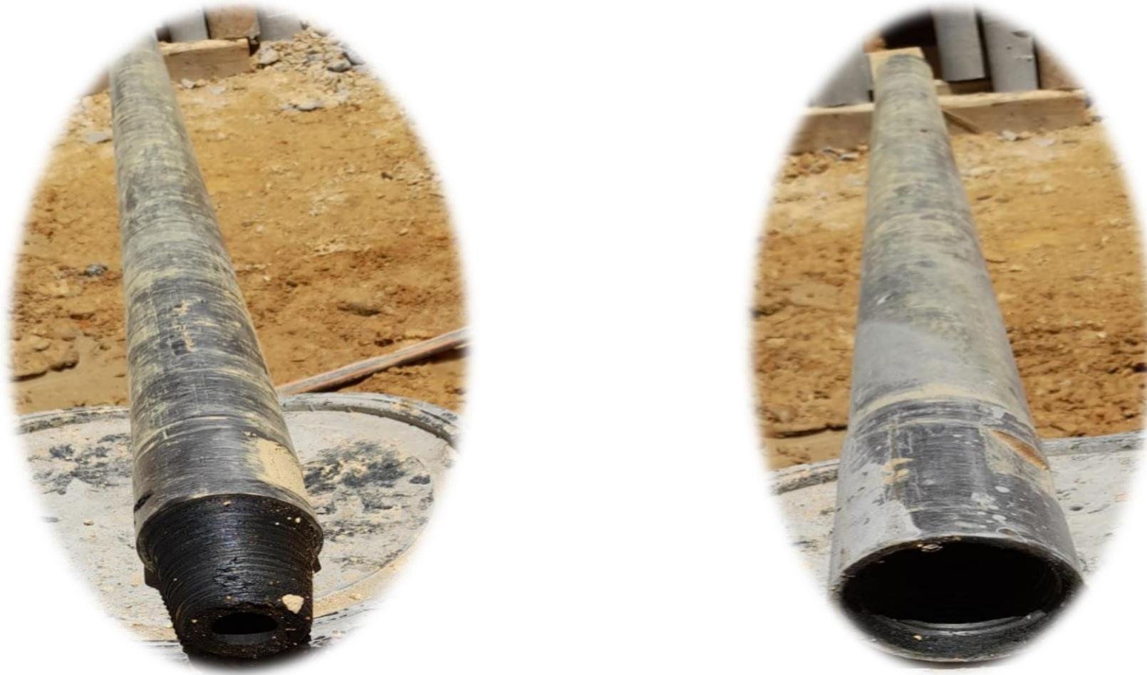
**Figura 2. Tubería de perforación y tubería de revestimiento**
