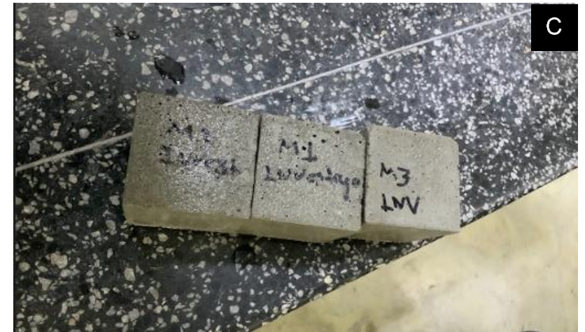
Imagen 5. A) Contiene: Llenado de moldes en cobre para muestras de mortero y apisonamiento de mortero según NTC 220. B) Contiene: Moldes para cubos de concreto con muestras ya vaciadas. C) Contiene: Muestras M1, M2, M3, cubos de mortero desmoldados.
