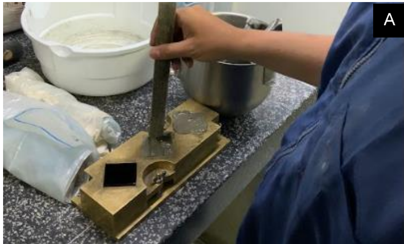
Imagen 5. A) Contiene: Llenado de moldes en cobre para muestras de mortero y apisonamiento de mortero según NTC 220. B) Contiene: Moldes para cubos de concreto con muestras ya vaciadas. C) Contiene: Muestras M1, M2, M3, cubos de mortero desmoldados.
