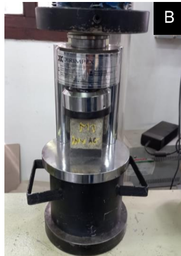
Imagen 6. Proceso para determinar la resistencia a la compresión en muestras de mortero. A) Contiene: Toma de medidas en muestra M5. B) Contiene: Muestra M1 en bloque de máquina de ensayo. C) Carga máxima registrada por la máquina de ensayo en la muestra M6 al momento de la rotura. D) Contiene: Muestras M9, M8, M7 luego de la rotura en máquina de ensayo.
