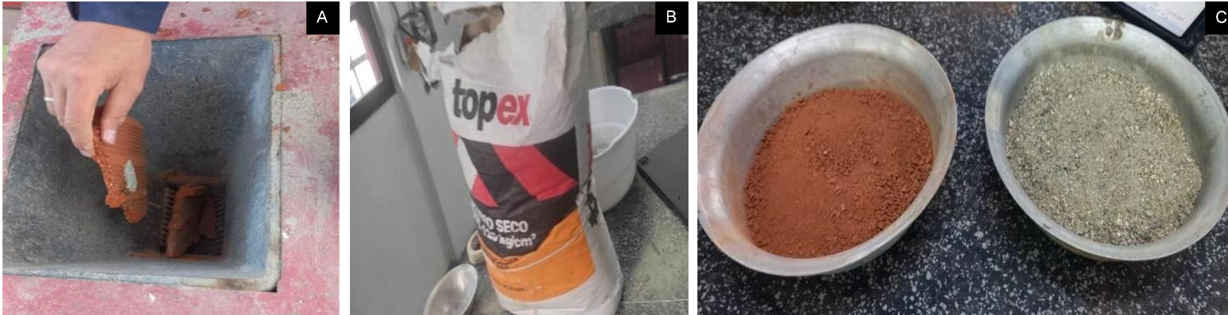
Imagen 2. A) Contiene: RCD de ladrillo a procesar, b) Contiene: Mortero Topex para elaboración del experimento. C) Contiene: Ladrillo triturado y arena de concreto para elaboración de las pruebas de laboratorio.
