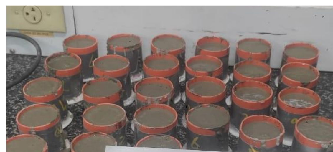
Figura 4. Sistema realizado con tubería de pvc de 2,5 pulgadas, retenedor de material de receo con lamina de zinc
