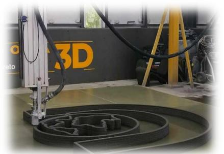
Figura 3. Impresora 3D - Conconcreto
