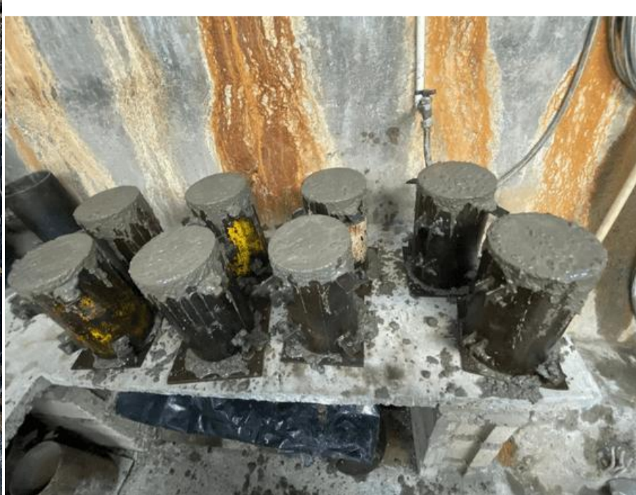
Figura 6: Cilindros concreto. Imagen propia
