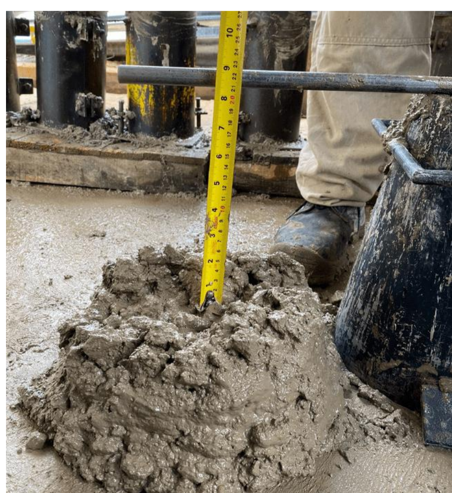
Figura 5: Asentamiento muestra concreto. Imagen propia
