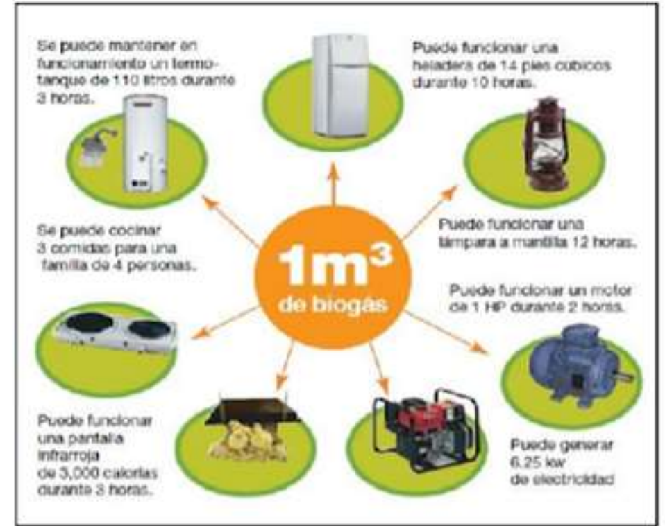
Figura 1: Usos del biogás
