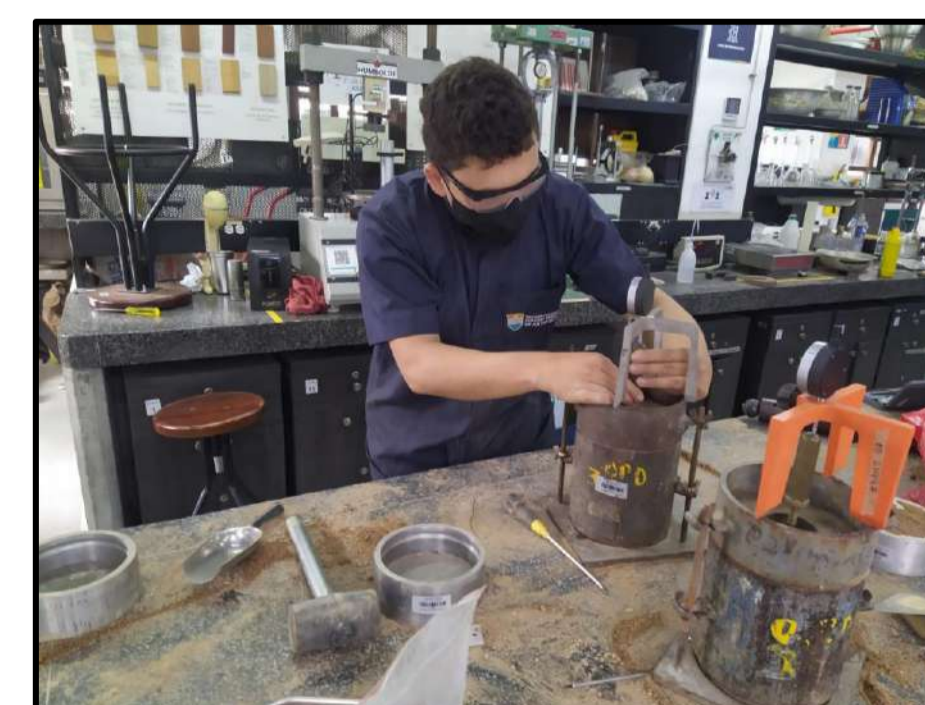
Imagen 1. Calibración deformímetros Elaboración propia
