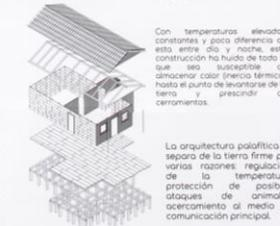
La cubierta de palma de terno con amiglos oleros crea un colchón aislante que protege la vivienda de la radiación solar, esta radiación es dispersada y el calor no penetra en el hogar, gracias a que se trata de un cubierta transpirable y auto-ventilada. Además la pendiente a dos o cuatro aguas permite la rápida evacuación de las aguas procedentes de los tormentos tropicales.
