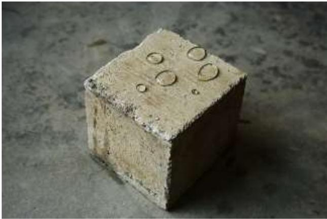
Fig. 1. Bloque de concreto con emulsión de parafina
