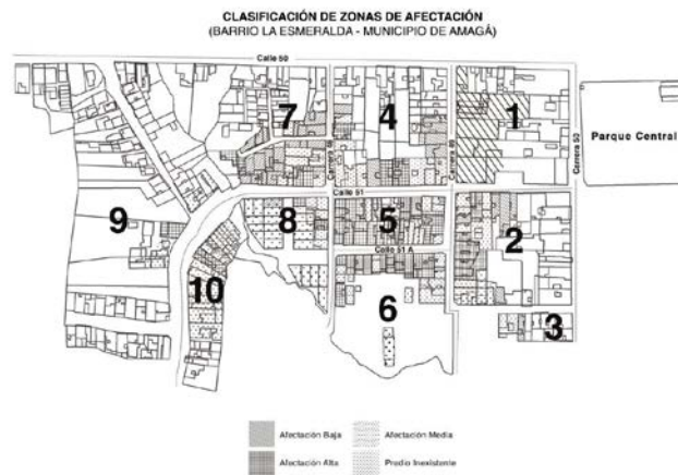
Figura 8: Planimetría del grado de afectación de las viviendas. Fuente: adaptado del plano catastral del municipio
