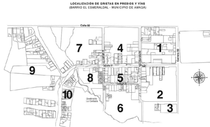
Figura 7: Plano de localización de grietas en el terreno en la zona de estudio. Fuente: adaptado del plano catastral del municipio
