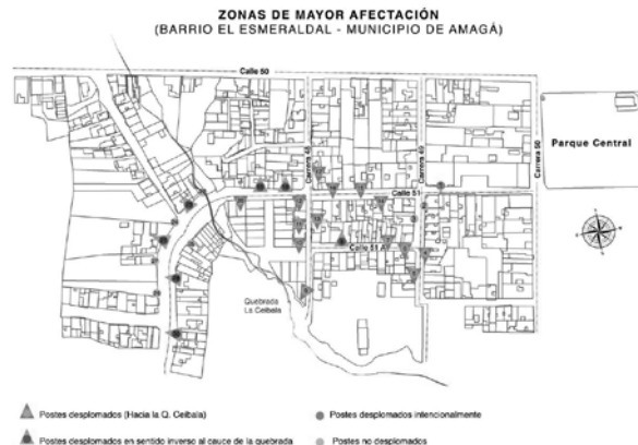
Figura 10: Ubicación y tendencia de inclinación de los postes de energía. Fuente: adaptado del plano catastral del municipio
