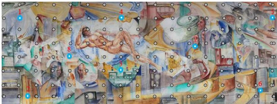
Figura 4: Puntos de control en ortomosaico para análisis fotogramétrico. Fuente propia
