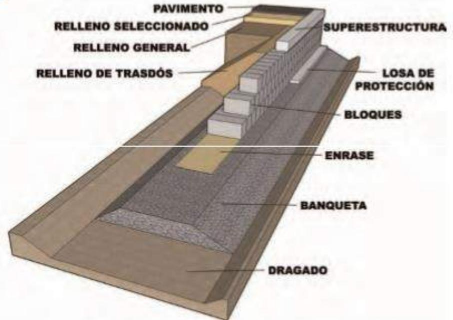
Figura 8.1.2.a C Secuencia constructiva muelle de bloques
