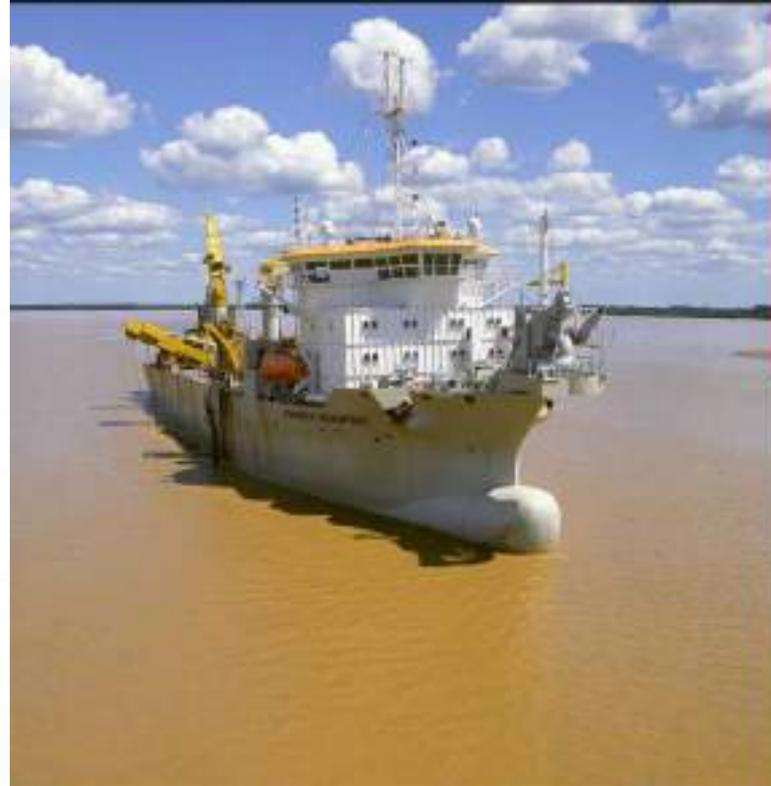
Río Paraná y Río de la Plata Waterway Concesión - Argentina. Trabajos de dragado de mantenimiento. Draga de succión en marcha
