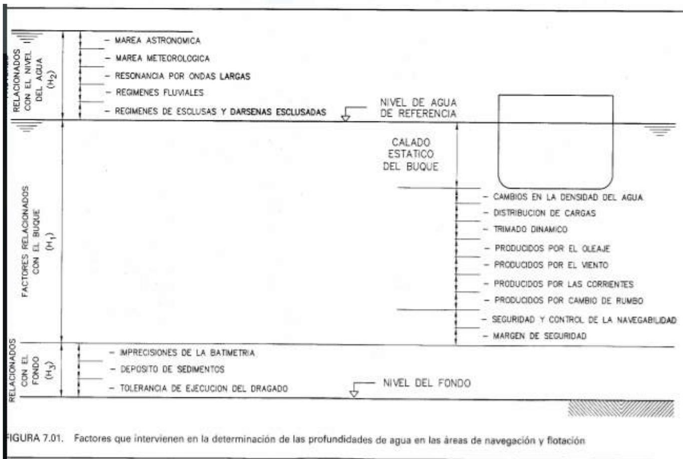
FIGURA 7.01. Factores que intervienen en la determinación de las profundidades de agua en las áreas de navegación y flotación
