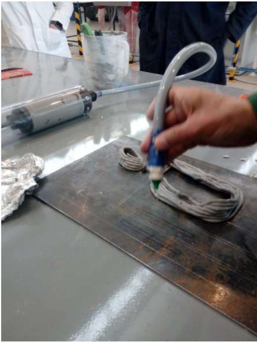
Impresión 3D cerámica, Instituto de Diseño e Innovación Tecnológica (IDIT), Universidad Iberoamericana Puebla.
