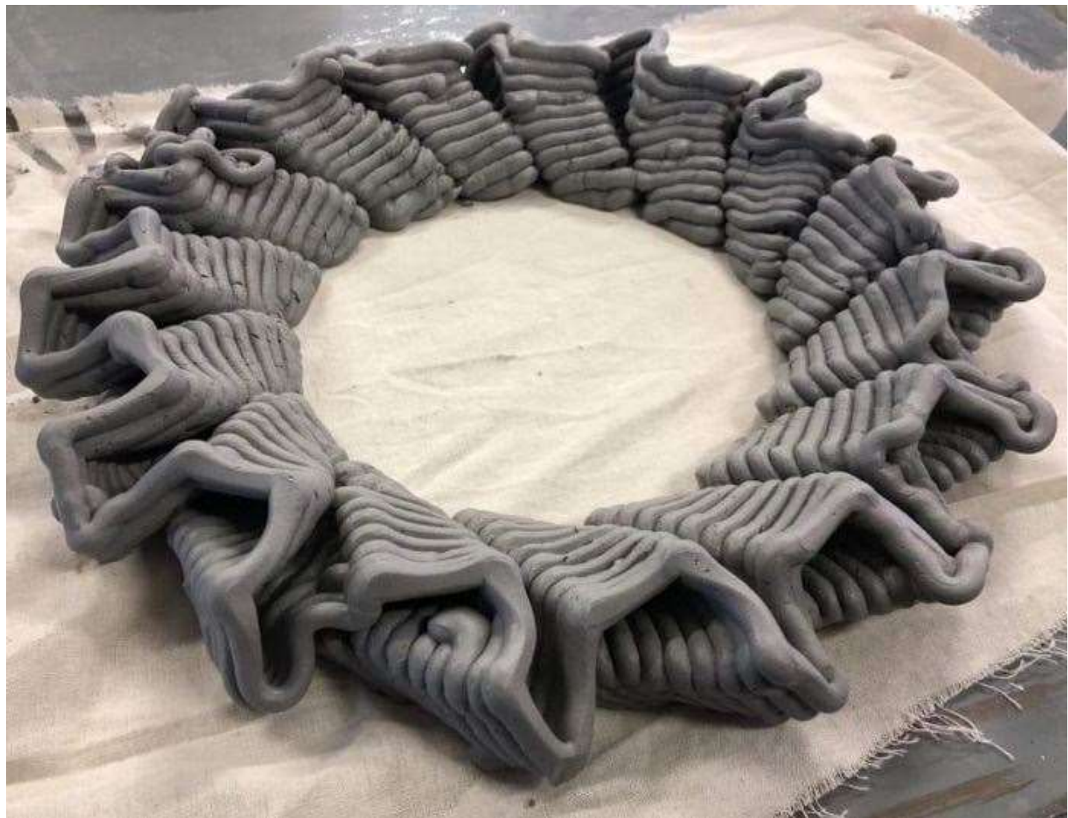
Impresión 3D cerámica, Instituto de Diseño e Innovación Tecnológica (IDIT), Universidad Iberoamericana Puebla.
