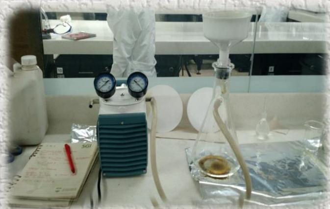
**Fotografía 8: equipo de filtración al vacío**
