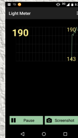
Toma de luz natural con luxómetro piso 8
