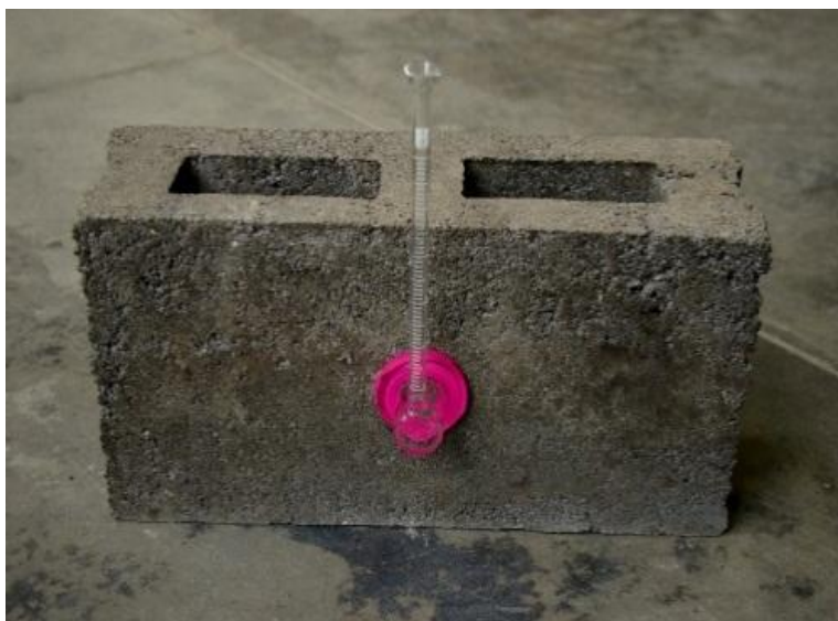
Fig.4 Método Rilem establecido en la norma (ASTM E 514, 2014)
