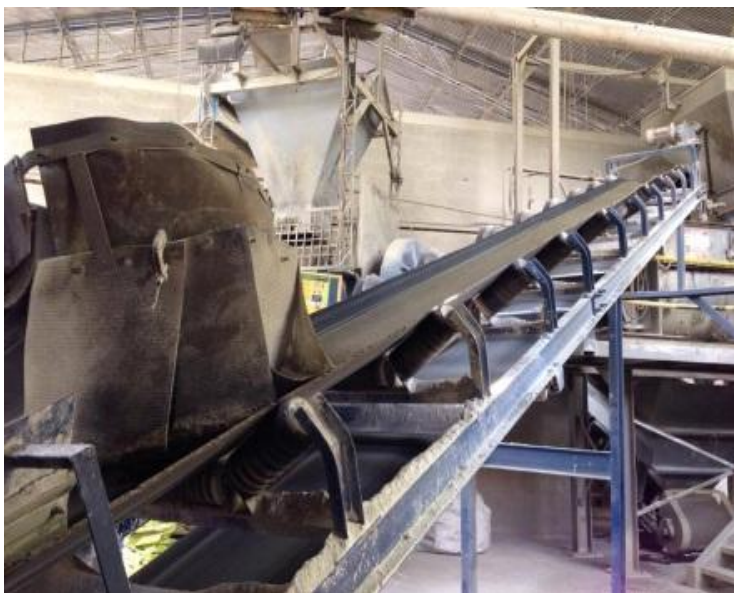
Fig.1 Mezcla transportándose en la banda transportadora
