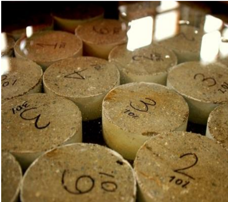
Fig.3 Probetas cilíndricas para ensayo de absorción capilar.
