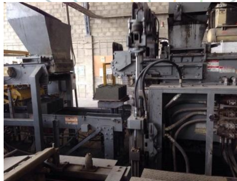
Fig.2 Salida de bloques de la maquina vibro compactadora
