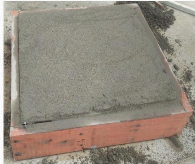
Figura 7: Mortero de revoque aplicado para curado – Fuente propia.
