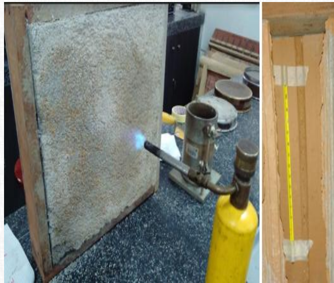
Figura 12: Muro expuesto al fuego – Muestra MC, M1, M2, M3 – Fuente propia.
