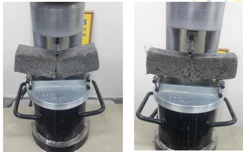
Figura 9. viga testigo (izquierda) y con fibra, ensayadas a flexión. Fuente propia
