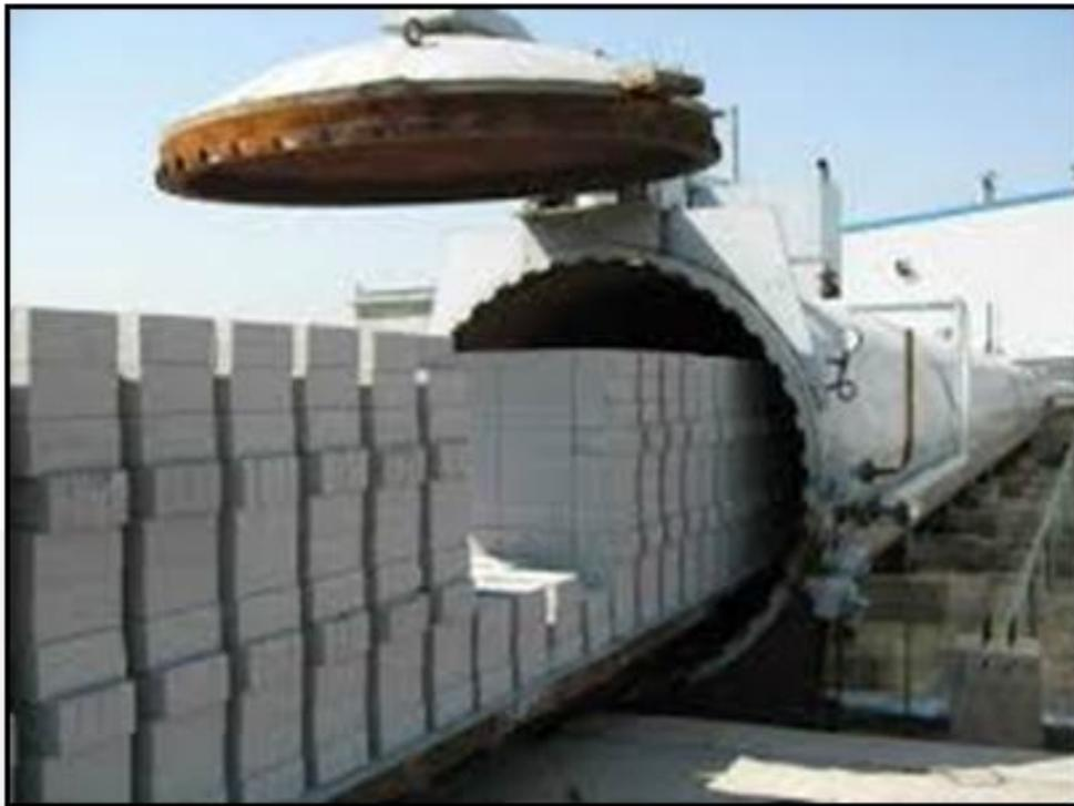
Foto 9. Proceso de curado con vapor de agua-autoclave
