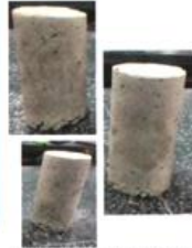
Cilindros vaciados y desencofrados
