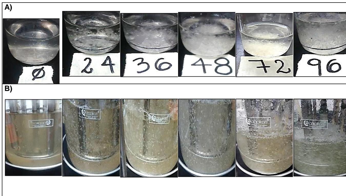
**Figura 1.** Crecimiento de *T. asperellum* GRBHA1 en un biorreactor de tanque agitado de 1,5 L con 1,2 L de medio TSM durante 96 horas. A) 20 mL de muestra tomados en las horas indicadas y B) contenido total del biorreactor.
