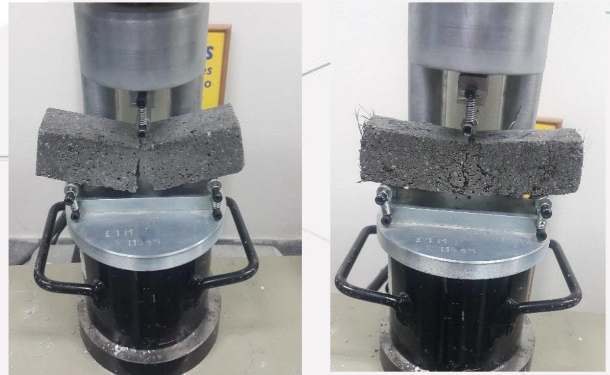
Figura 9. viga testigo (izquierda) y con fibra, ensayadas a flexión. Fuente propia
