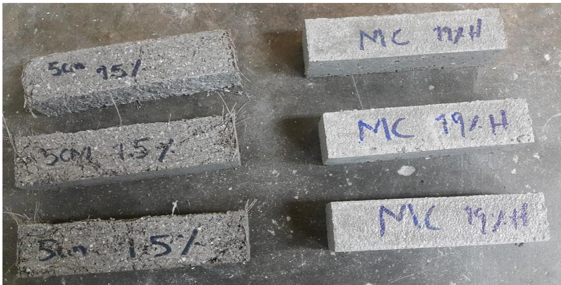
Figura 8. viga con fibra de 5cm y con un volumen 1,5% y muestra control,. Fuente propia
