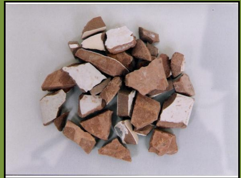
Agregado grueso reciclado de baldosas cerámicas
