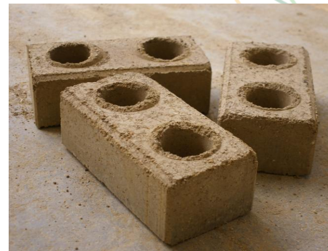
Imagen 2: Bloques de tierra comprimida, fuente propia
