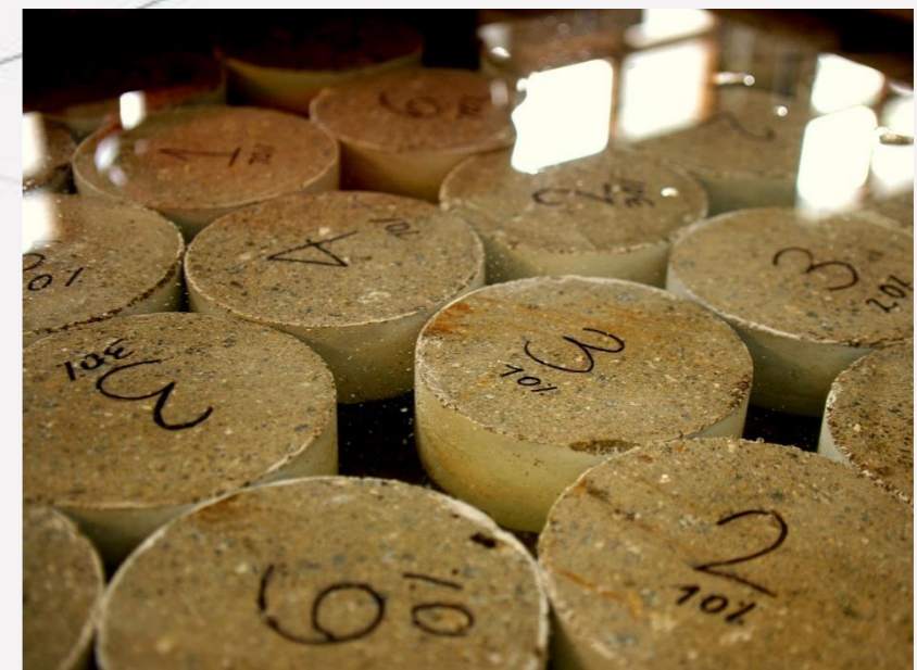
Probetas cilíndricas para ensayo de succión capilar
