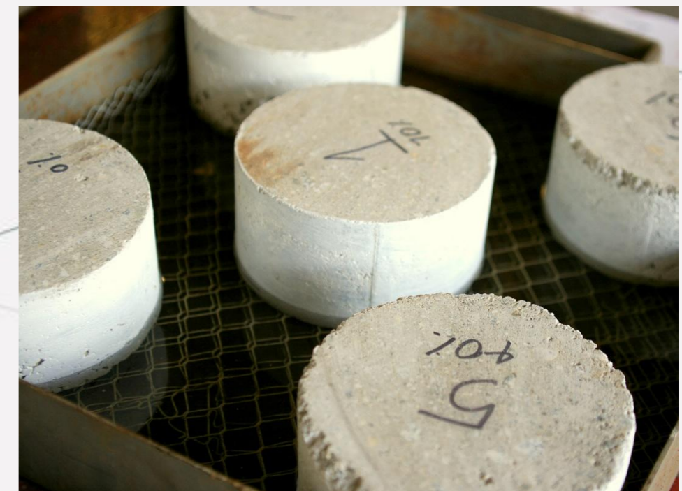
Probetas cilíndricas para ensayo de succión capilar
