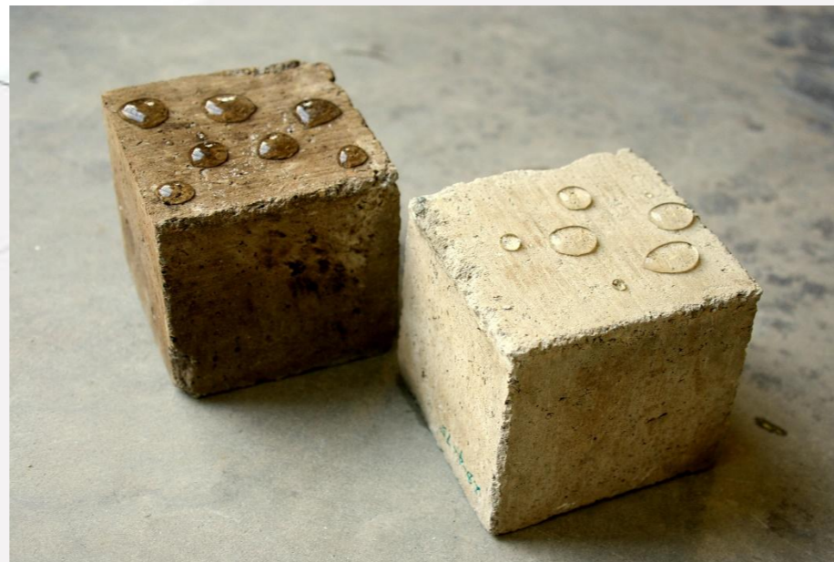
Muestras de concreto con adiciones de compuestos bituminosos y emulsiones de cera parafinada
