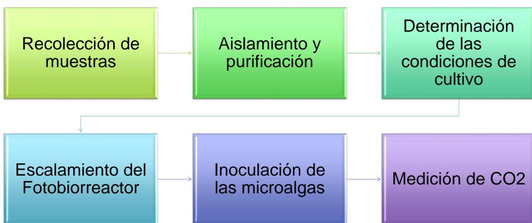
Esperamos identificar y aislar las microalgas del tipo *Chlorella* sp. y *Scenedesmus* sp., con el fin de determinar las condiciones del cultivo y escalarlo en un fotobiorreactor en el cual se evalúe la eficiencia de acuerdo a las variables anteriormente pre seleccionadas.
