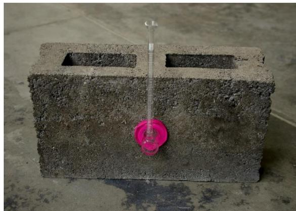
**Figura 3:** Ensayo de permeabilidad de los bloques de concreto mediante método Rilem
