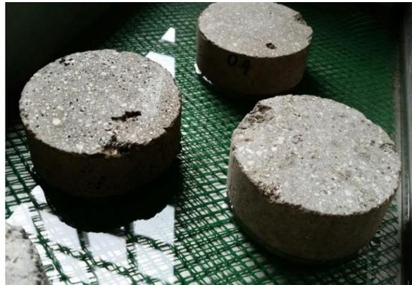
**Figura 1:** Análisis de succión capilar
