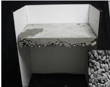
**Losa de concreto:** se vacía una loseta de concreto de 5 cm de espesor
