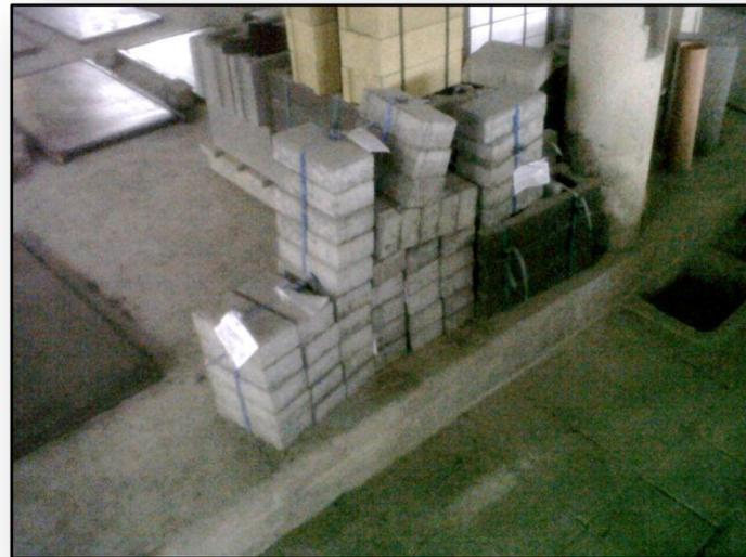
Imagen15, Proceso curado adoquines
