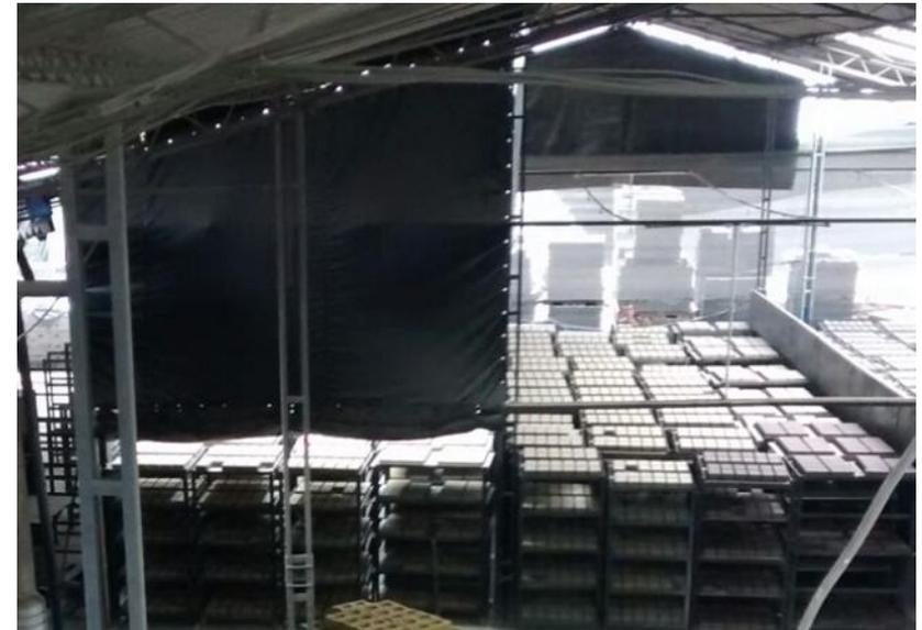
Imagen14, Proceso fraguado adoquines
