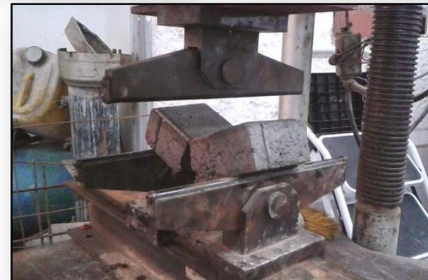
Imagen19, Ensayo Módulo de rotura
