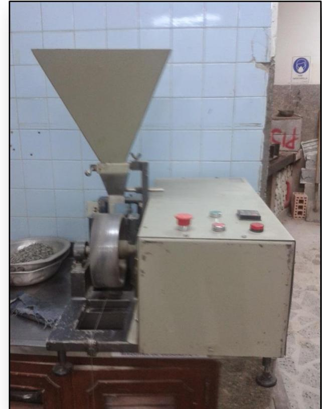
Imagen20, Máquina de desgaste
