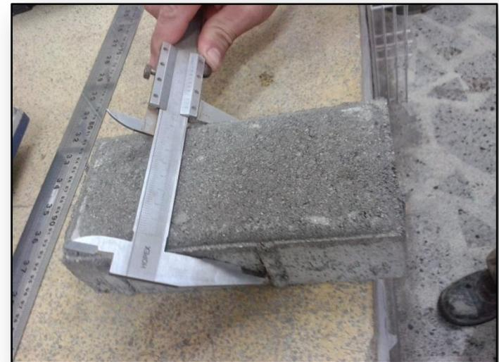
Imagen16, mediciones adoquines
