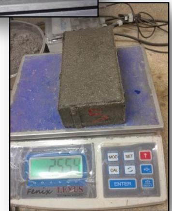
Imagen17, ensayo absorción
