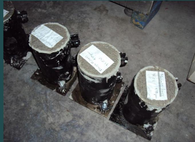
*Cilindros de concreto reciclado*
