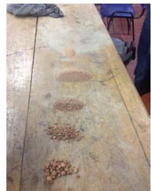
**Fotografías 15. a 18. Realización de prueba de granulometría**
